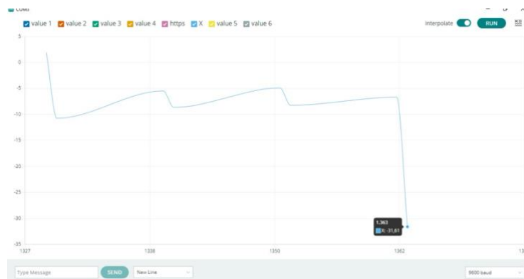
Figura 3 – Gráfico do sinal de aceleração durante o teste de queda simulada
